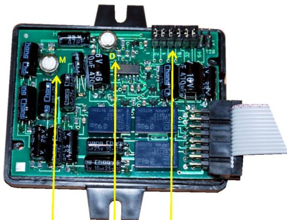
Перемычки установки № квартиры
