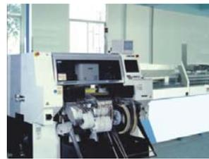
Станок установки печатных элементов
