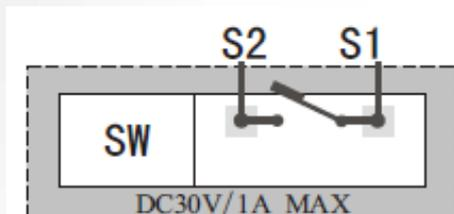
SW является опциональным дополнительным выходом, мощное реле может переключать 30 В / 1 А. В обычных условиях, удерживайте кнопку управления примерно 1 секунду, до выдачи монитором сигнала «ДИ», контакты выхода замкнутся. Если вы отпустите кнопку, клеммы выхода разомкнутся через 3 секунды.
