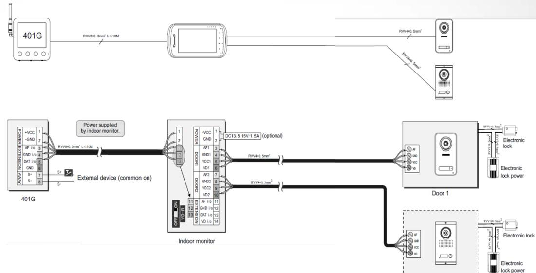
GSM 900/ DCS 1800 модуль для беспроводной передачи звонков с вызывной панели на телефон и мобильный телефон.
