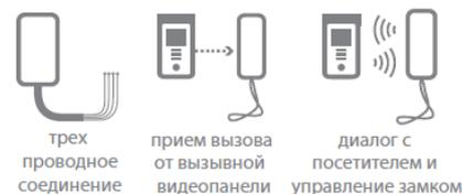
Аудиотрубка для подключения к обычной четырехпроводной вызывной видеопанели (3 провода - аудио, плюс и минус). Оптимально для многоквартирных систем и многокнопочных панелей с целью оптимизации затрат. Открытие двери происходит с помощью замыкания сухих контактов непосредственно на трубке, управление сухими контактами вызывной панели не поддерживается.
