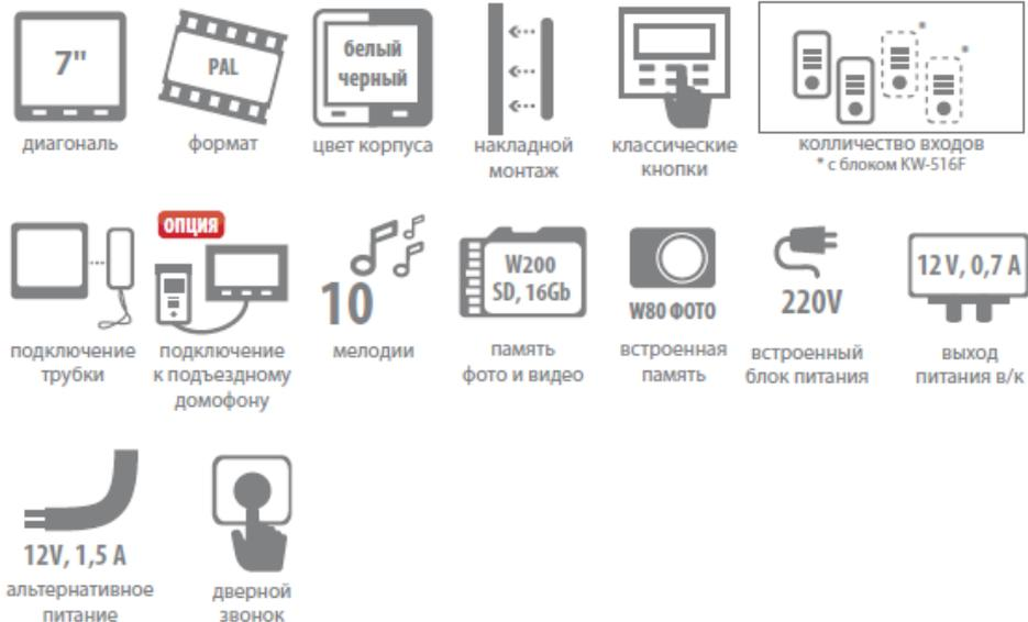
KW-E705C / KW-E706C Монитор цветного видеодомофона, hands-free, LCD TFT 7", 16:9, PAL/NTSC, до 2 вызывных панелей/видеокамер, возможность подключения дополнительной аудиотрубки Kenwei, 10 полифонических мелодий вызова, совместимость с любыми вызывными панелями. Возможность питания видеокамер от монитора (выход 13,5V,1,5A), а также возможность подключения дверного звонка. Питание 220V (встроенный блок питания) или от 12V.
