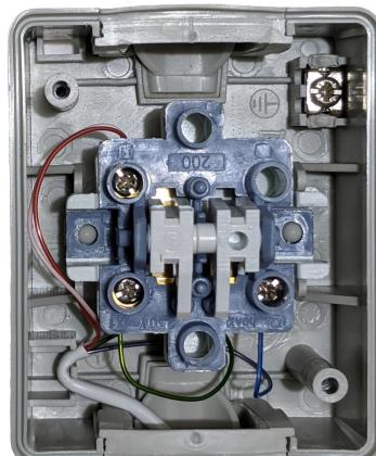
Снимите изоляцию с обеих сторон кабеля приблизительно на 60 мм. Зачистите концы каждого из проводов кабеля: которые идут на выключатель на длину 8-10 мм, которые идут на турникет на длину 5-6 мм. Скрутите желтый и коричневый провода между собой с обоих концов кабеля. Загните вдвое очищенные от изоляции концы проводов, которые идут на выключатель.
