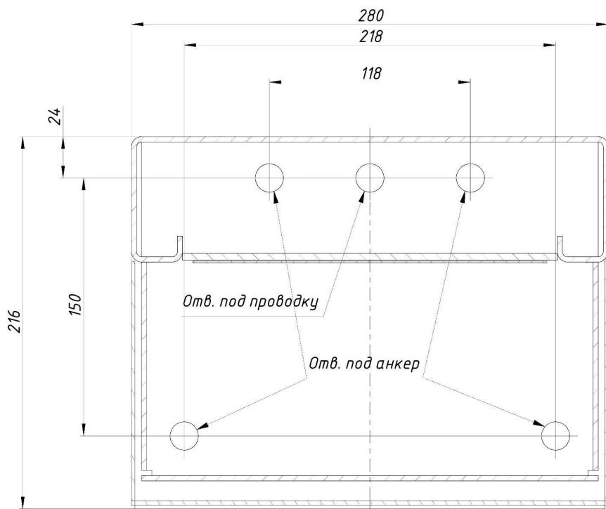
Вставьте гильзы анкеров в выполненные отверстия так, чтобы они не выступали над поверхностью пола. Снимите нижний кожух турникета поз. 3 открутив два винта крепления нижнего кожуха поз. 7. Установите стойку турникета на гильзы анкеров и закрепите ее болтами M12. Выполните последовательно для обеих стоек турникета.
