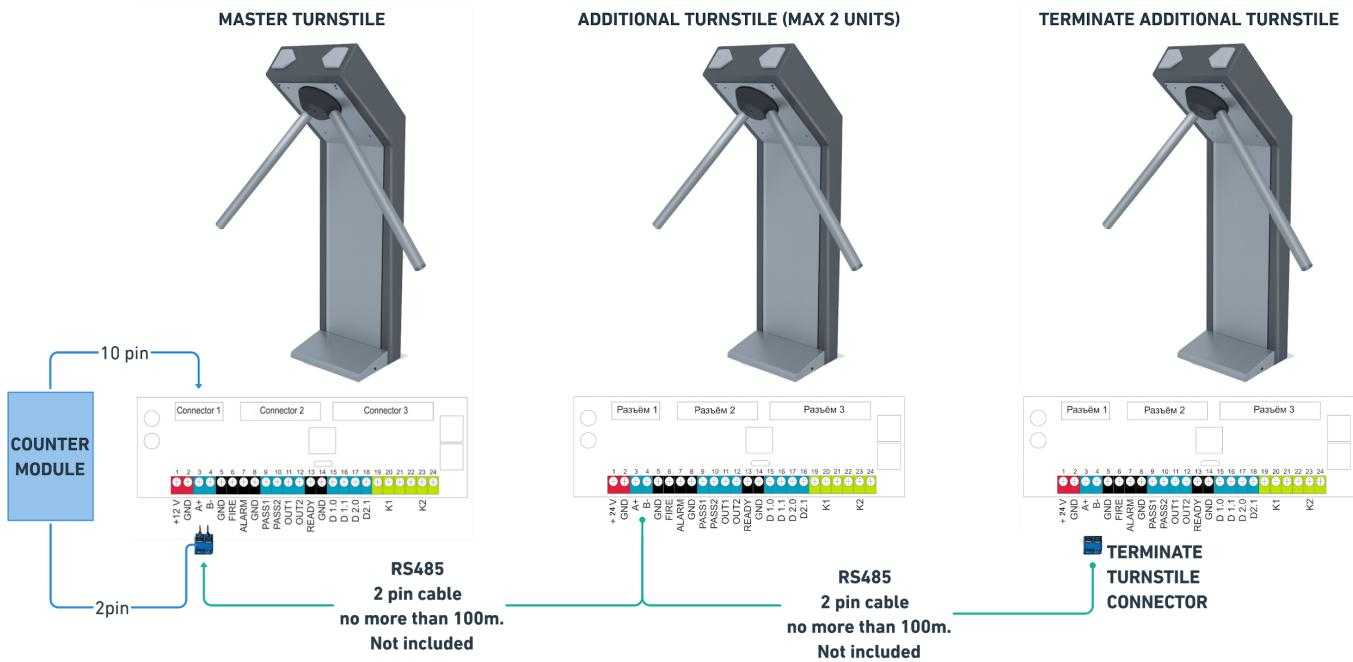
Линия связи должна представлять собой один кабель витой пары (UTP 1x2). К этому кабелю присоединяются все приемники и передатчики. Расстояние от линии до микросхем интерфейса RS-485 должно быть как можно короче, чтобы уменьшить рассогласование и отражения сигналов.
