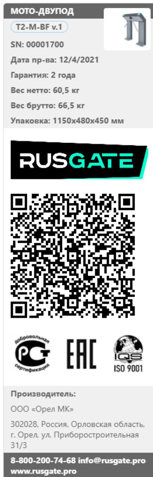
Турникеты имеют физическую маркировку в виде ламинированных влагостойких этикеток, расположенных на лицевой части механизма под Передним кожухом. Чтобы считать информацию с этикетки необходимо демонтировать Передний кожух п.2, предварительно отсоединив преграждающие планки. Этикетка имеет следующий вид:
